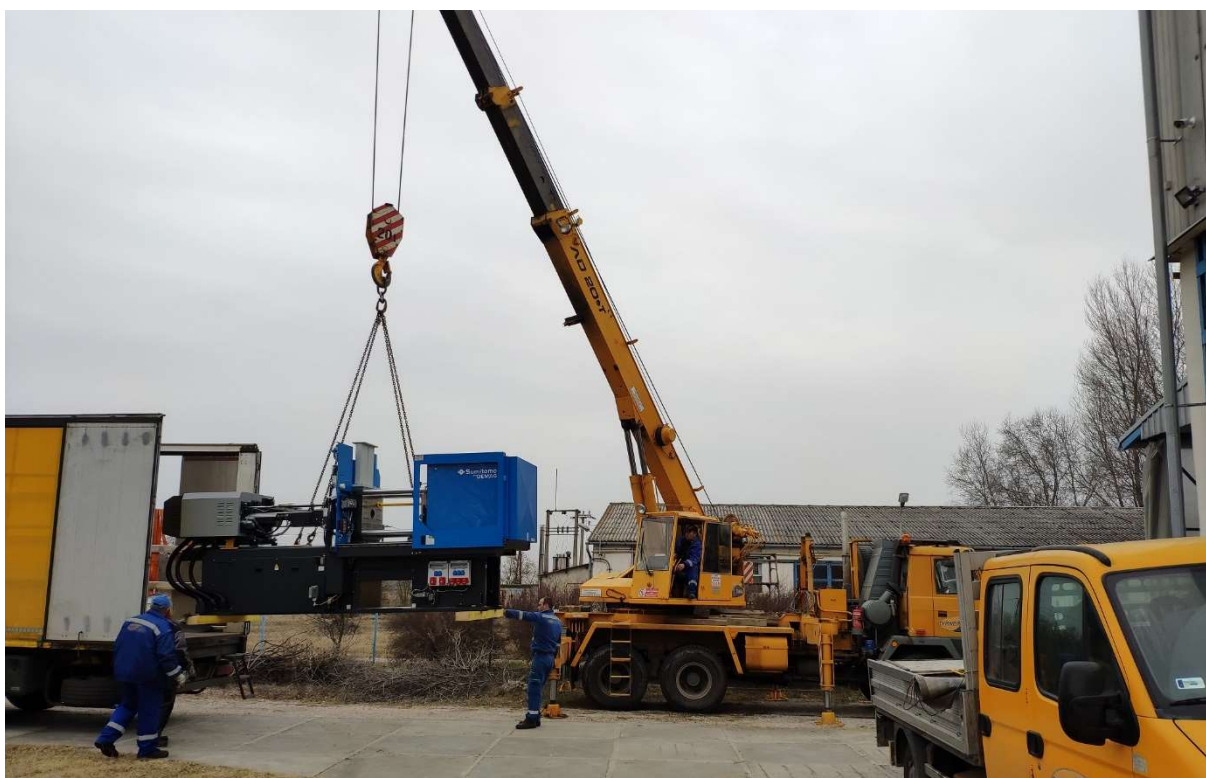
4. ábra a fröccsöntőgép a darun
